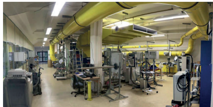
FÖDISCH besitzt einen eigenen Staubkanal, um verschiedene Betriebszustände zu simulieren.
